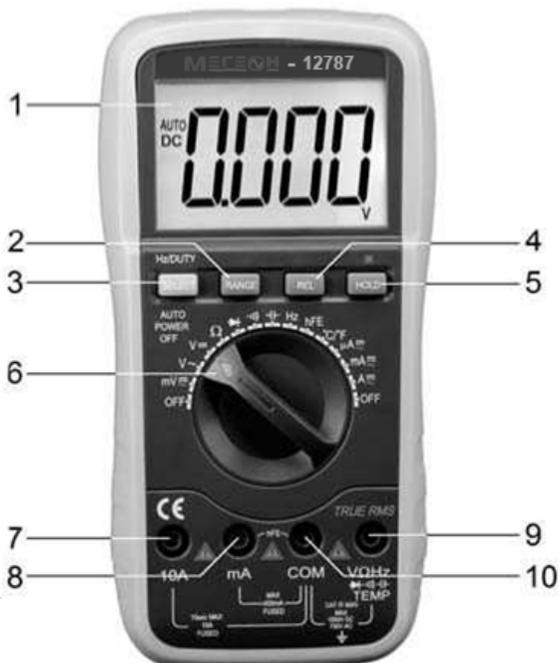
1. ЖК-дисплей: отображение результата измерения
